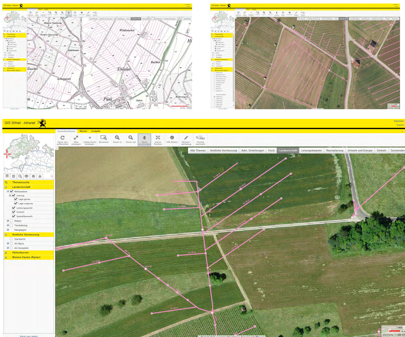
Abb. 3-5: GIS SH: Meliorationsleitungen.
