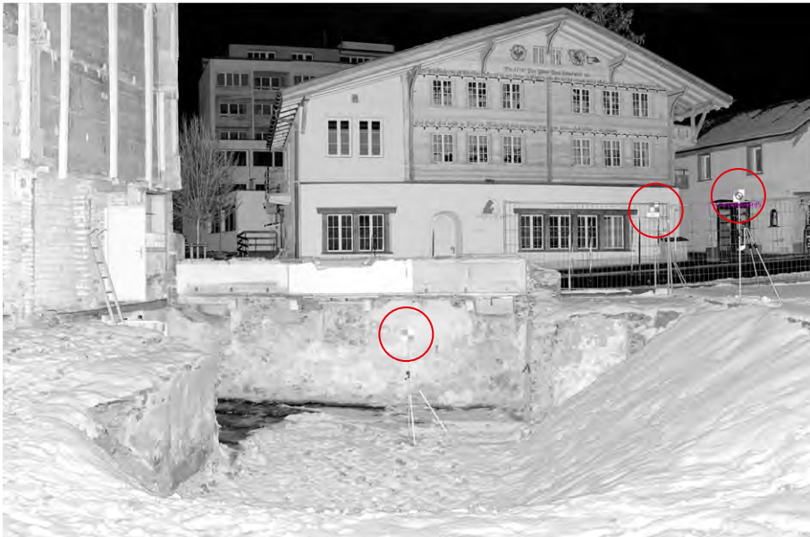
Abb. 2: Ausschnitt eines Scanstandpunktes mit Referenzpunkten (hier als Schachbrettzielmarken).
